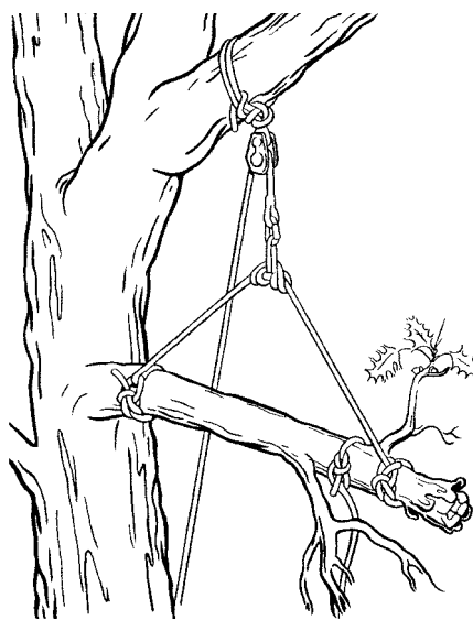
Vyvázaná větev za použití několika částí výbavy. Vyvažovací smyčka je navázaná na konce větve pomocí kluzných dračích smyček. Těžiště je nastavené prusíkem který je ke spouštěcímu lanu připojen ocelovou karabinou. Na větev je navázáno směrové lano ke kontrole pohybu větve kolem vertikální osy.
