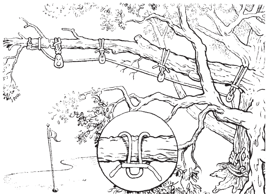
Obr. 1 Vrcholová část dubové větve uvázaná pomocí techniky rybářského prutu. Směrové lano bude minimalizovat zhrounutí. Detail ukazuje nastavitelnou smyčku, jež je uvázaná kolem větve pomocí liščí smyčky.
