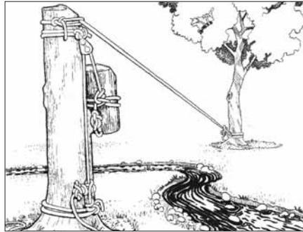
Obr. 1: Typické nastavení lanovky. Spouštěný kus je zachycen do spouštěcí kladky a poté je připnut na lanovku a připraven na místo určené
