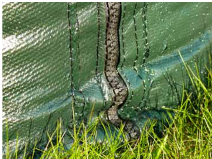
Způsob uvolňování vody přes šev u zavlažovacího vaku Great Value A
