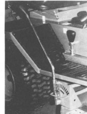
Malotraktor Westwood S 1000 je vyba- ven čtyřtaktním motorem Briggs and Stratton o 2,6 kW, záběr žacího ústrojí 40 cm, výška kosení nastavitelná od 1,3 do 4,1 cm, sběrač pokosené trávy o kapacitě 36 l, hmotnost stroje 23 kg.
